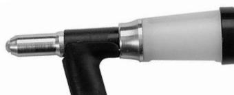
Toto zařízení po provedení nýtového spoje odsává odtržený nýtovací trn a samočinně ho přepraví do zachtevávací nádoby. Další výhoda spočívá v tom, že nýt, zavedený do vyústění, zůstává zachován i při držení hlavy pistole v mechanismu sklíčidla ve svislé poloze. Vakuové odsávací zařízení je možné dodat jako kompletní konstrukční sadu a je možné ji namontovat i dodatečně na stávající pistole pro jednostranné uzavírané nýty GESIPA.
