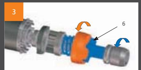
Das Schlagwerk schlägt seitlich auf den Amboss (6). Der enorme Schlagimpuls wird über die Spindel an die Schraube weitergeleitet.
