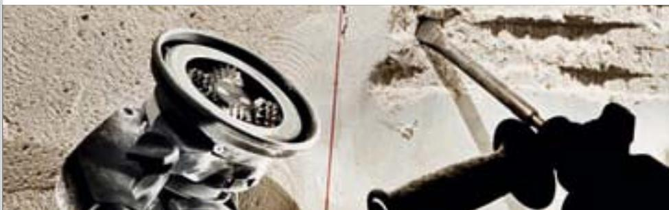
Der Vergleich zeigt: mit PROTOOL RenoFix arbeiten Sie schneller und präziser als mit herkömmlichen Methoden. Beim Abtrag von 1 qm Putzfläche ist der RenoFix RGP 80 doppelt so schnell wie ein Bohrhämmer. RenoFix spart aber nicht nur 50% Ihrer Arbeitszeit beim Abtrag sondern spart durch die effektive Staubabsaugung auch noch lästige Reinigungszeit.
