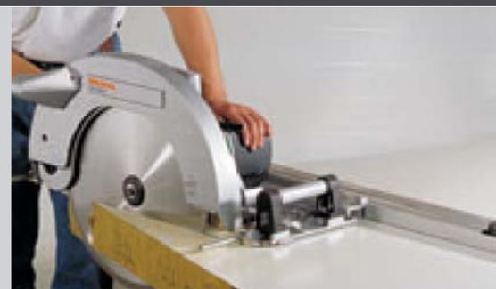
**Sandwich-Paneele** für den Hallenbau, Container- und Fassadenbau zusägen. Mit Führungssystem und Spezialsägeblatt. Einzelblechstärke bis max. 2 mm.
