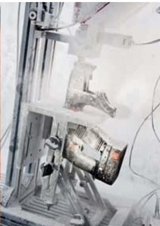
**Dauerhafte Funktionssicherheit garantiert.** Der Einsatz im aggressiven Gipsstaub ist die alltägliche Herausforderung eines Trockenbauschraubers. Extremer Dauereinsatz in der Staubkammer konnte DuraDrive auch nach einer Million Schraubzyklen nichts anhaben.
